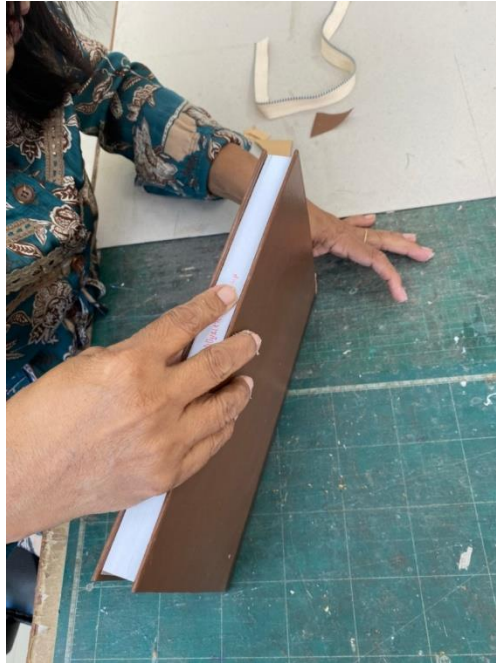
ภาพที่ 2.45 ตัวอย่างการเช็คความพอดีของปกและหนังสือ
