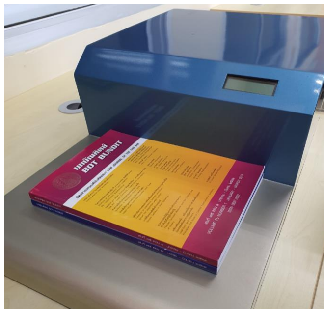
ภาพแสดงการวางวารสารบนเครื่องอ่าน RFID
